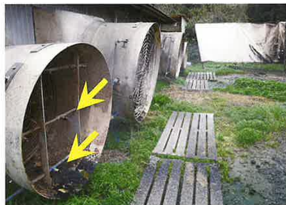
除塵装置（矢印：水の噴霧ノズル）
