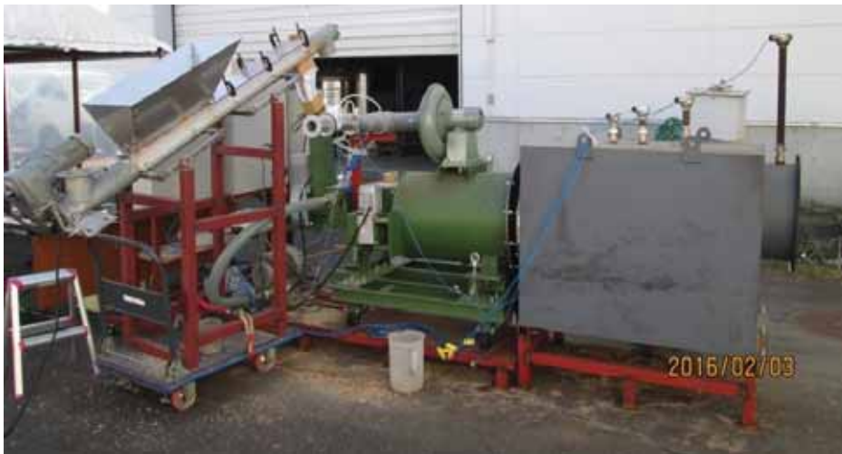
図 1-8 ロータリーキルン式燃焼試験装置
