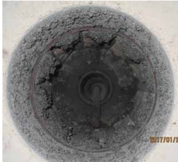
図 1-18 ウッドシェーブ混合馬ふんペレット 燃焼後の熔融状況
