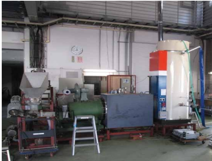
図 1-11 ダイオキシン測定時の燃焼試験全景 (灰出しボックスに水冷式熱交換器を接続した)
