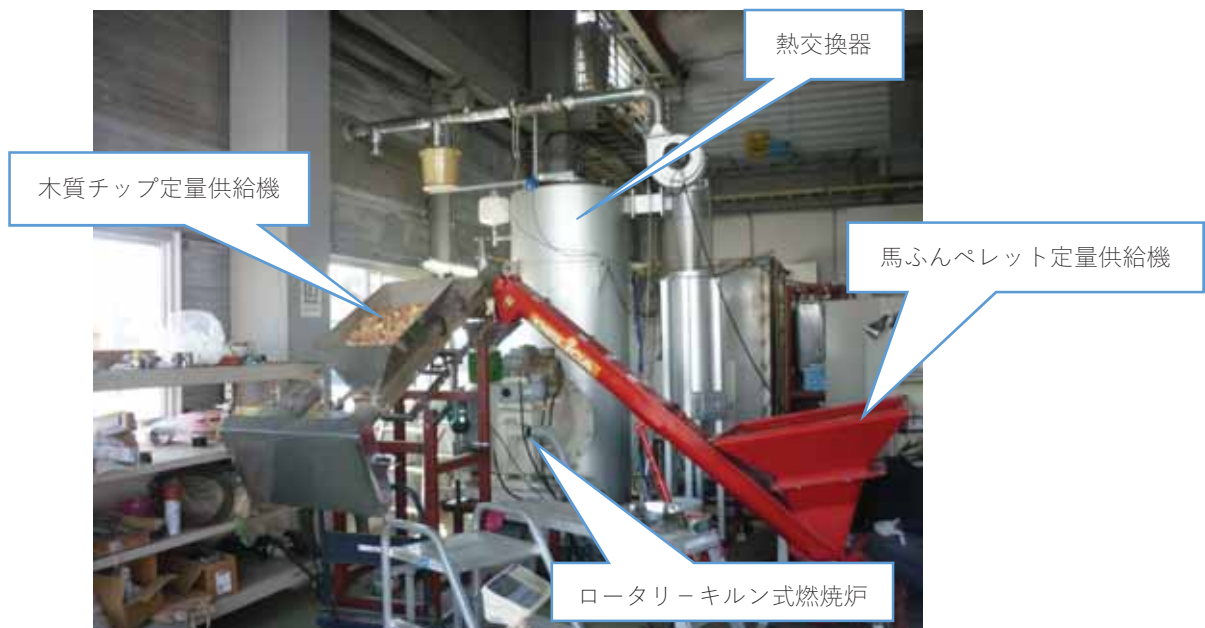
図6 ロータリーキルン式燃焼炉の燃焼システム
