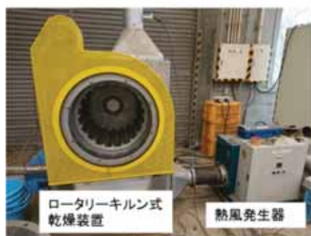
図 2-1 ロータリーキルン式乾燥装置 注：熱風は斜め下から上方向に吹抜ける
