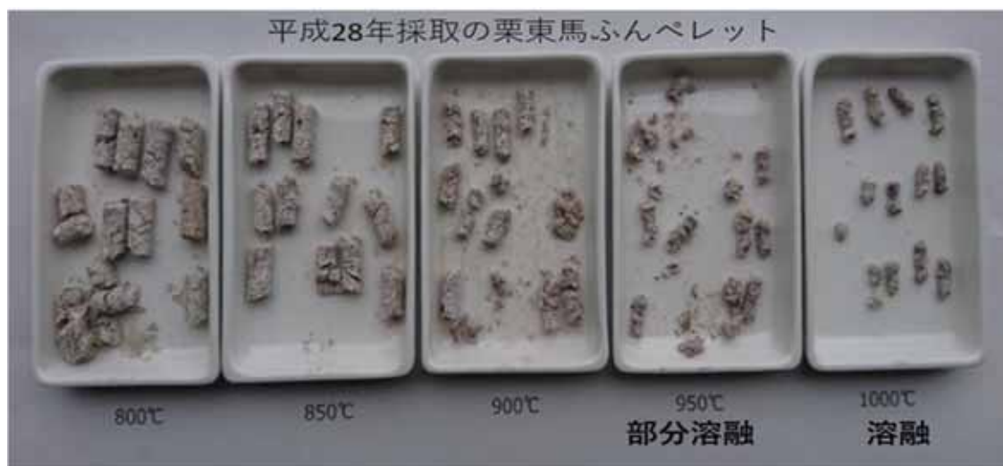
図 1-6 栗東トレーニングセンターのウッドシェーブ混合馬ふんペレットの温度別の溶融状況
