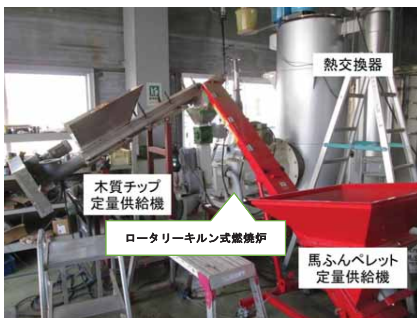
図 1-21 ロータリーキルン式燃焼炉の燃焼システム
