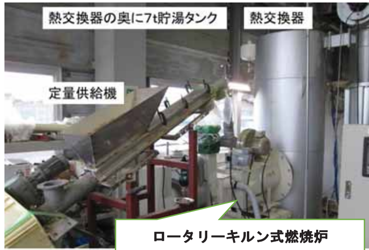
図 1-15 ロータリーキルン式燃焼炉の燃焼システム
