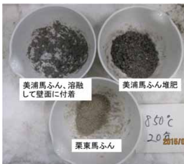
図 1-1 燃焼灰の性状(850°C)
