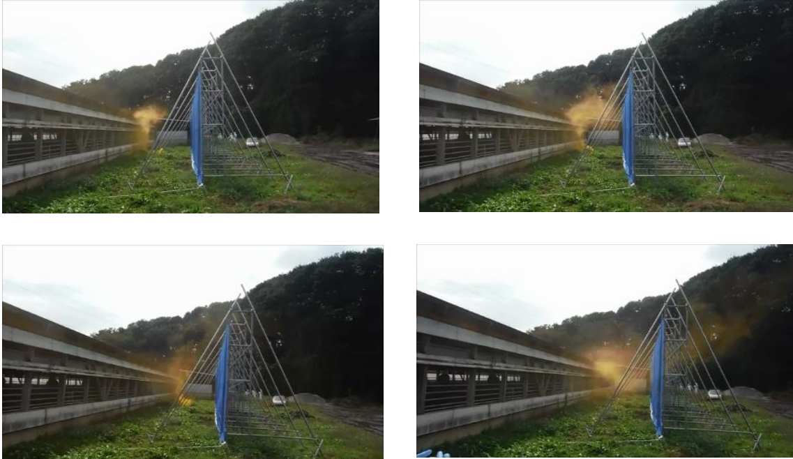
写真1 発煙筒による臭気の流れ
