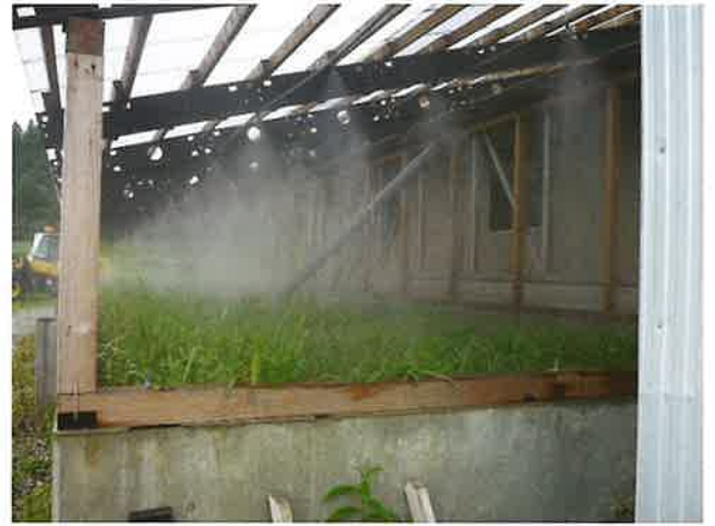
写真4 散水中の土壌層
