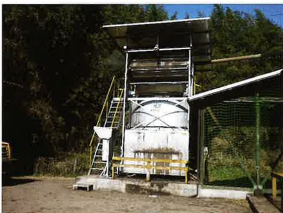
写真 1 密閉縦型堆肥化装置
