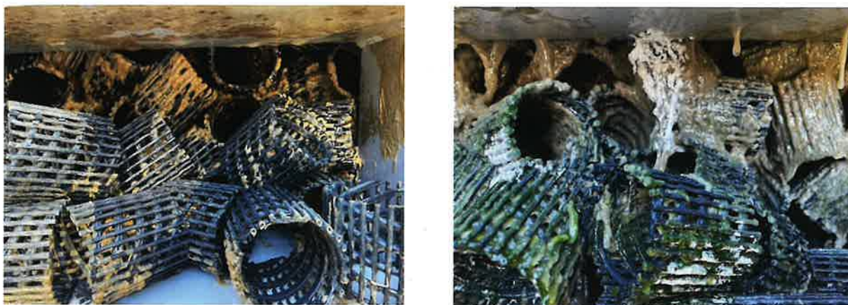
写真2 スクラバー稼働3ヶ月後の充填剤のバイオフィルムの付着状況 (左：試験区(膜処理水区)、右：対照区(地下水区))
