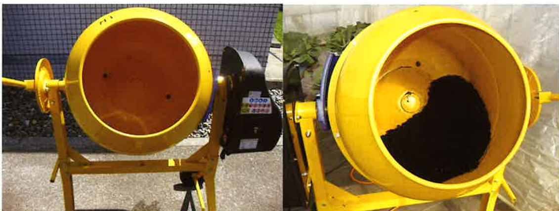
写真 7-7 造粒試験に供した市販品の電動式コンクリートミキサー
