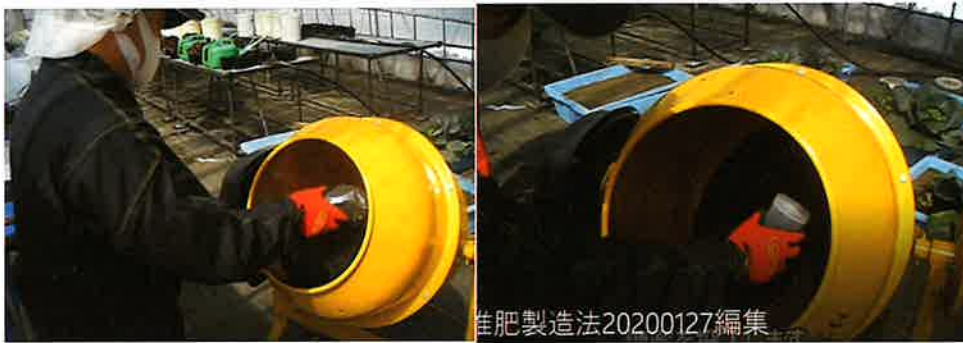
図 7-2-2 回分連続折衷方式による造粒のでき方のイメージ
