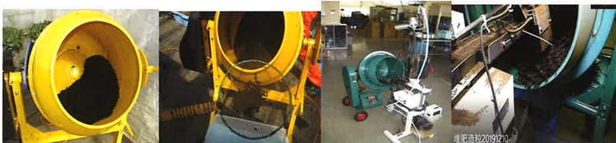
写真1 家畜ふん堆肥の造粒調製に使用した実験機器と造粒の様子（左2枚：市販のコンクリートミキサーと造粒、右2枚：連続式の実験装置と造粒）
