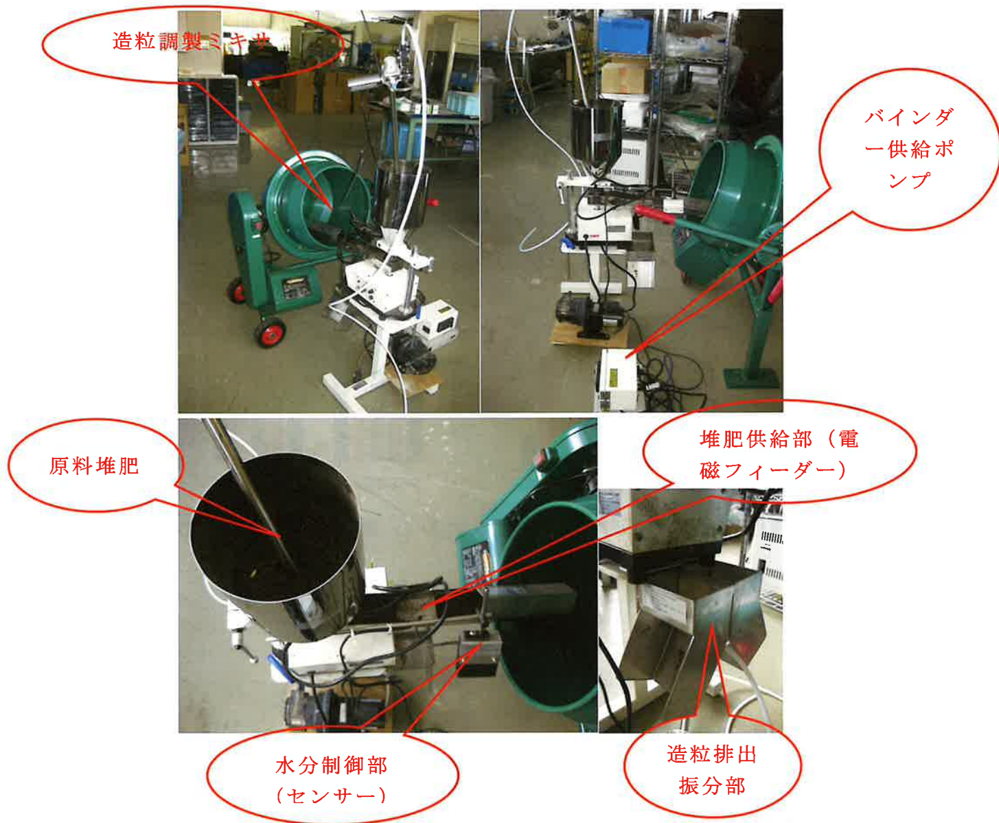
写真 7-9 連続式造粒物調製システムにおける機器
