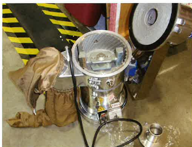
写真 7-3 ハンマークラッシャー粉碎器（1時間に10kg程度粉碎可能）
