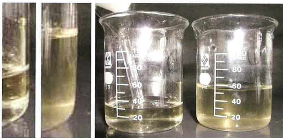
図63 二次処理水（ばっ気沈殿処理水）のろ過前（右）とろ過後（左）との比較
