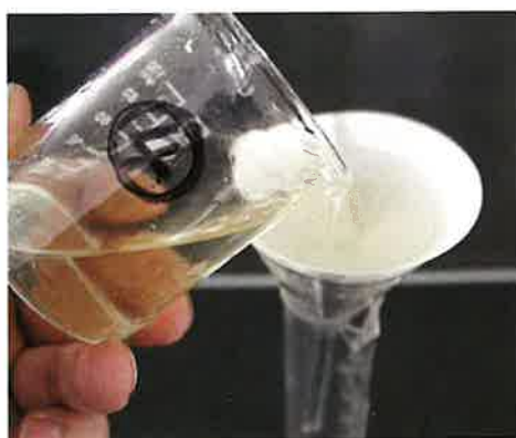
図62 二次処理水（ばっ気沈殿処理水）をろ過する
