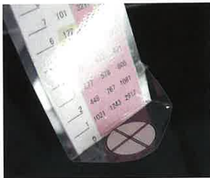
図51 自作透視度計の十字部分（完成）
