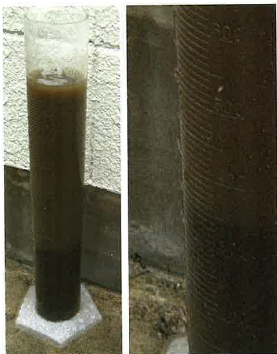
図16 汚泥が多くてばっ気も不足している時のSV30
