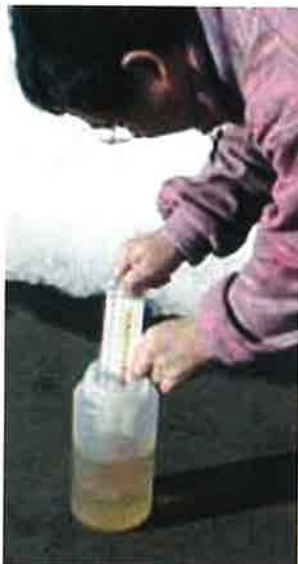
図59 自作透視度計による透視度の測定
