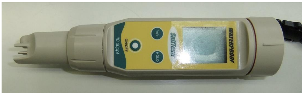
pH計とEC計が一体化されたポケット型測定器の事例
