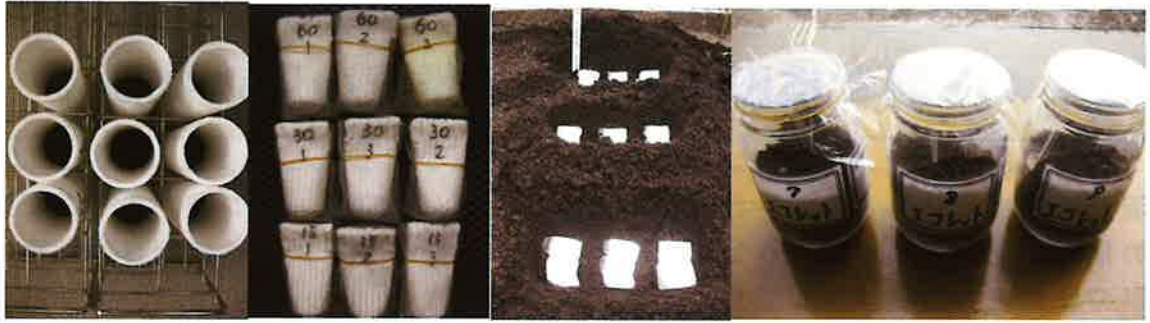
写真2 ガラス繊維ろ紙を用いた土中埋設試験（左3枚）、瓶培養試験（右）
