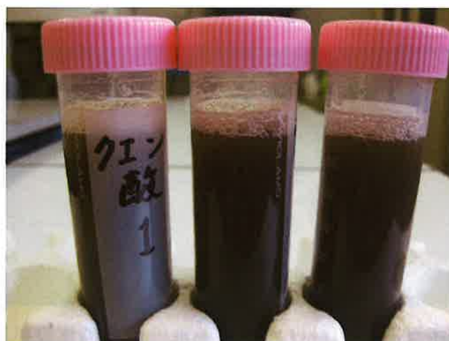
写真 9-5 リン酸、カリの肥効率推定のための2%クエン酸抽出の様子 (30℃の温度条件下で1時間振とう抽出します)
