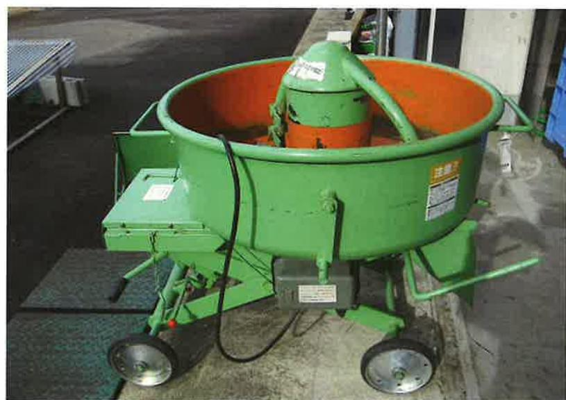
写真2 堆肥材料の混合機
