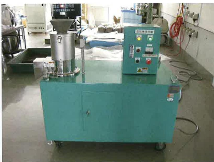
写真3 高肥料成分ペレット堆肥の調製に供した成型機
