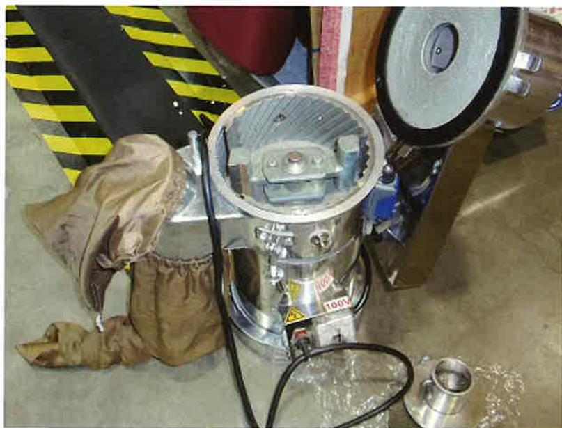
写真1 堆肥原材料の粉碎機
