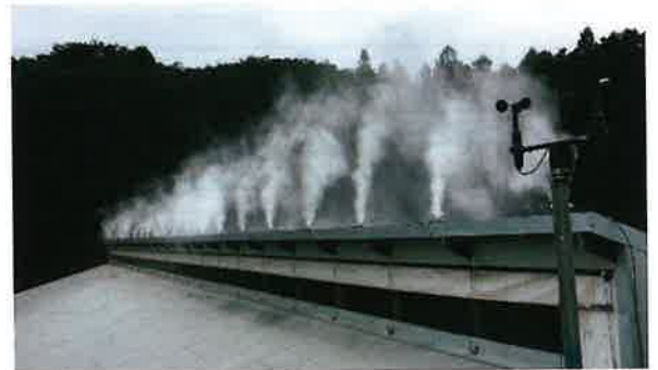
写真 2 資材の噴霧中の様子 ・繁殖豚舎屋根から散布 ・ノズル粒径 34 \mu m ・噴霧量 270ml/分
