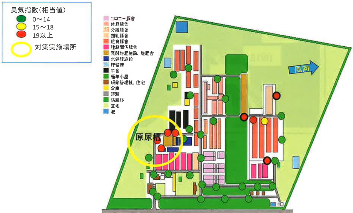
図1 農場内の臭気マップによる臭気の測定
