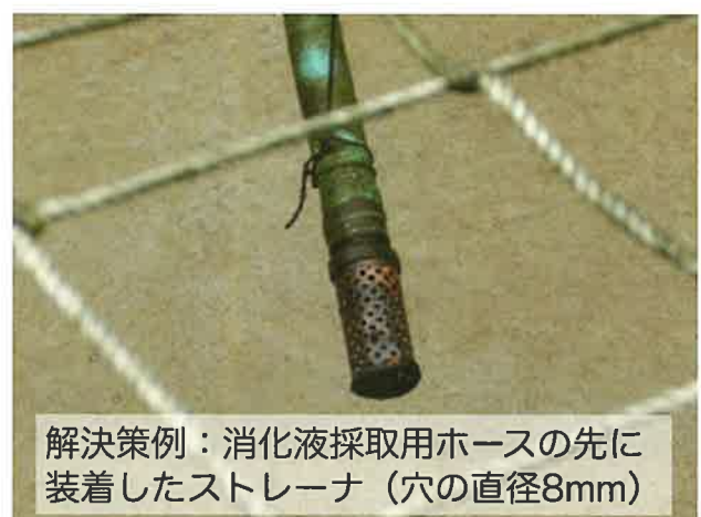
図20 輸送・散布のトラブルと解決策の例
