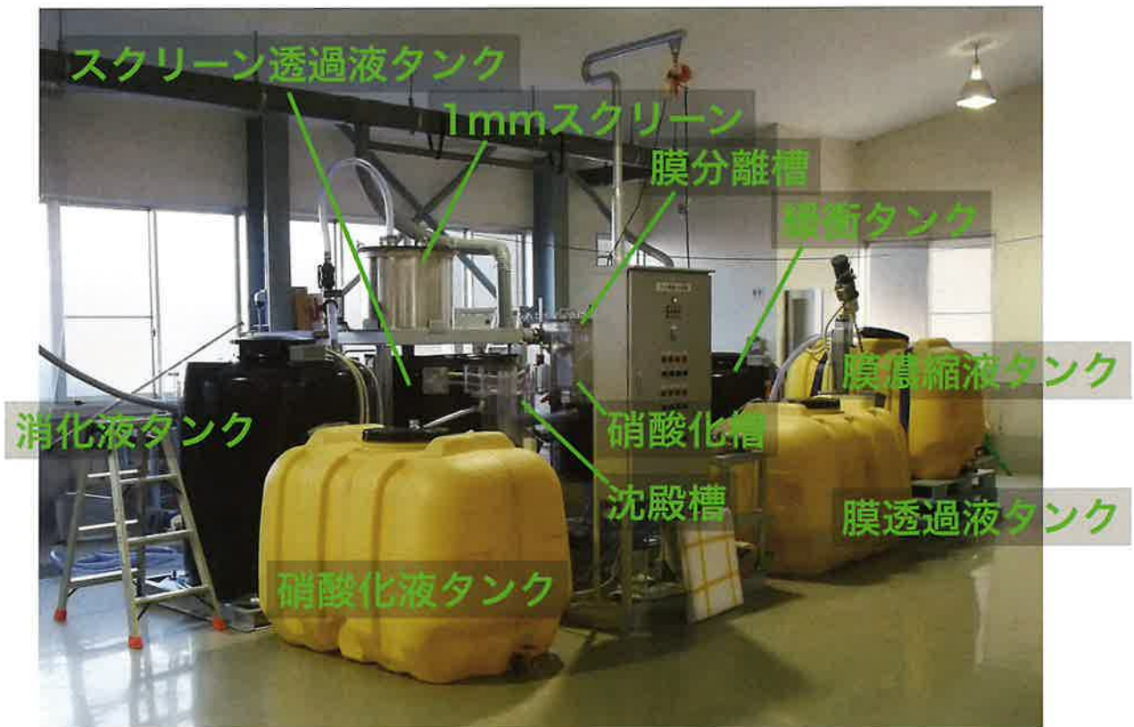
図27 濃縮・改質実験装置の図面（上）と外観（下）
