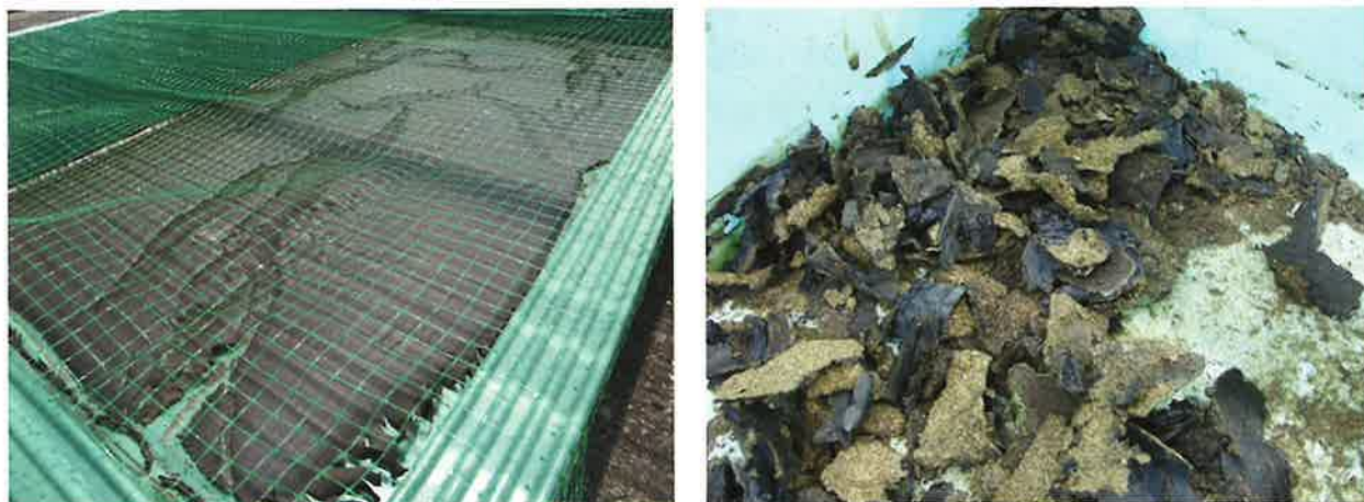
図39 乾燥途中（左）と乾燥後（右）のT施設の膜濃縮液
