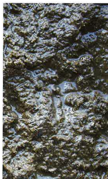
図33 スクリーン残渣の外観（全て同縮尺）
