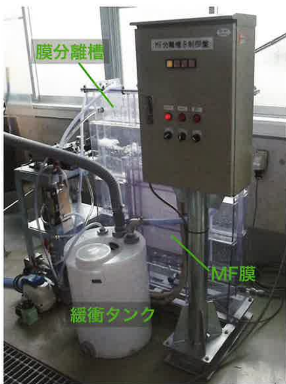
図28 小型膜分離実験装置 (中に水を入れた状態)
