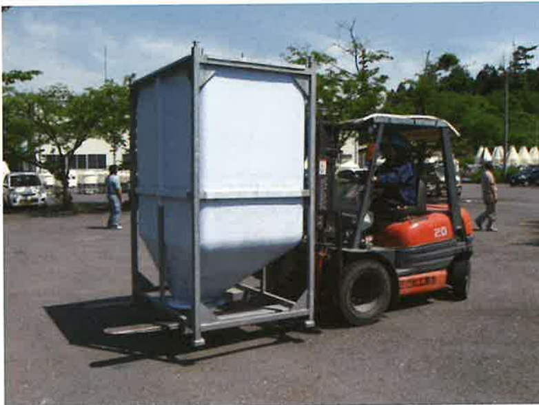
写真12 カセット式輸送ボックスを運搬している様子 （燃料が風で飛散しないため、作業性が良い）
