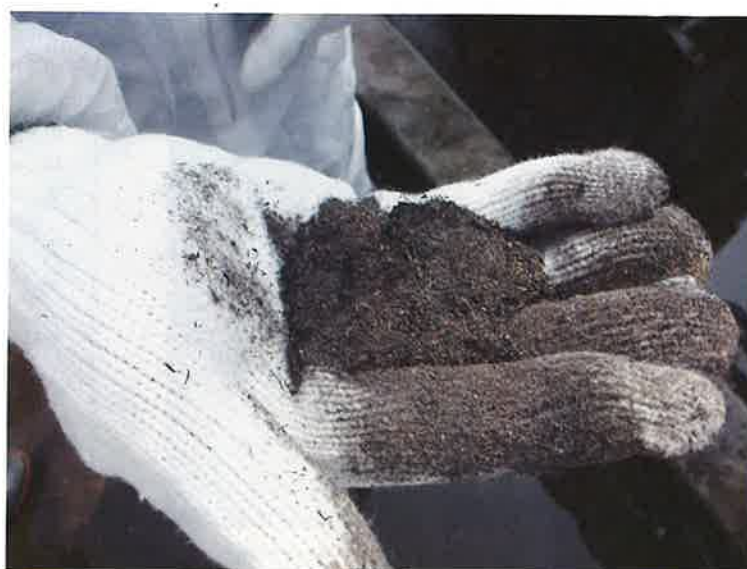
写真11 堆肥から生産した複合バイオマス燃料
