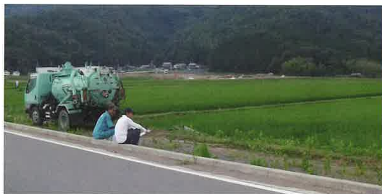
写真6 バキューム車から直接水田に流し込んでいるところ
