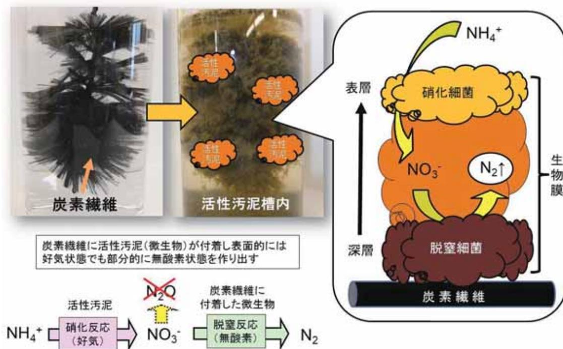
図 48 炭素繊維担体を用いた場合の曝気槽内の窒素除去反応
