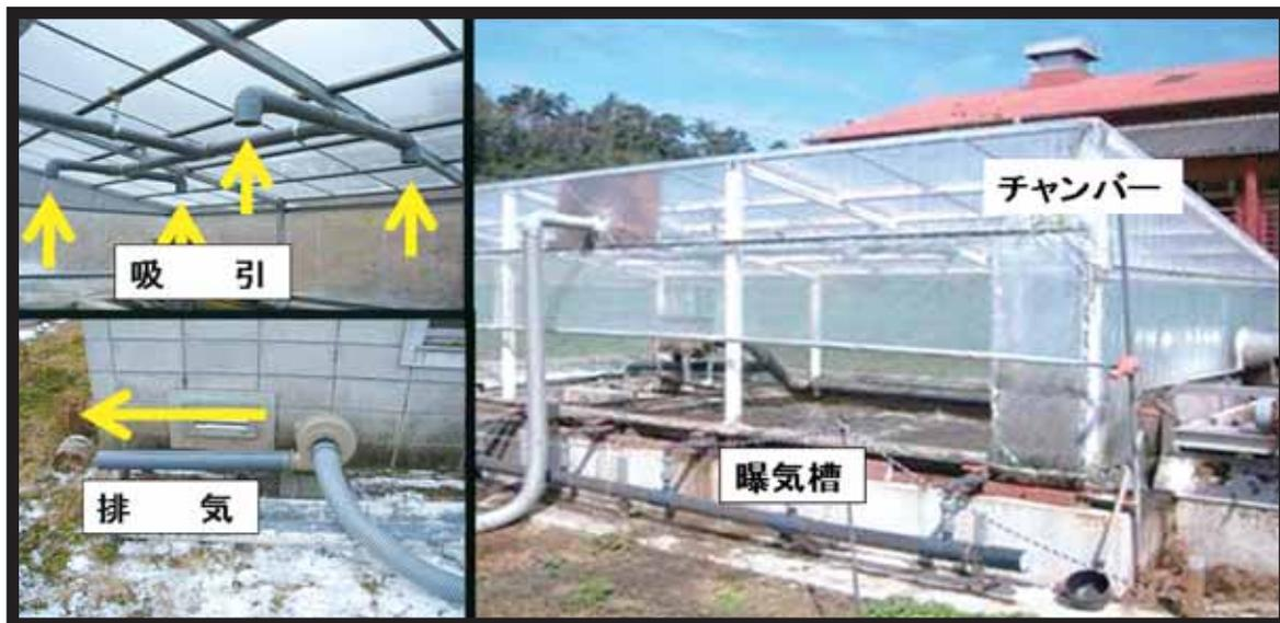
図 13 GHG の測定システム（牛舎排水：画像）
