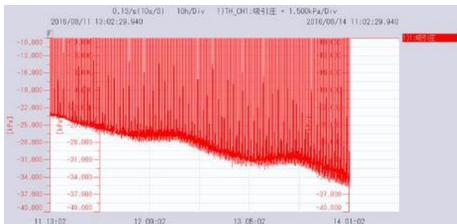
図 66. 樹脂粒無添加での閉塞発生状況 (下縁が定流量ろ過時のろ過差圧の変化を示す)
