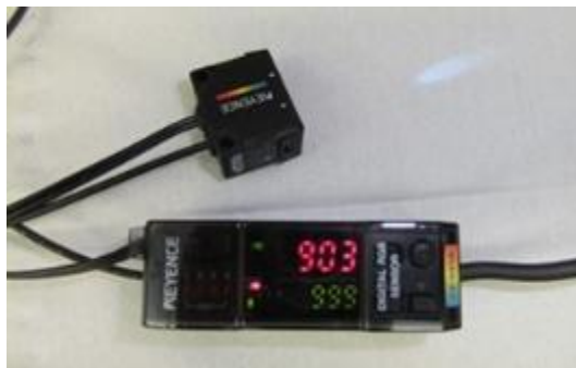
図 159. 使用した RGB センサー (上: センサーヘッド、下: アンプ部)
