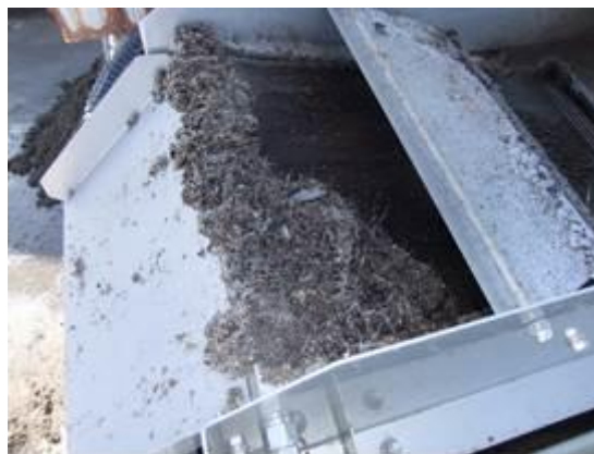
図 117 スクリーンで除去された豚毛
