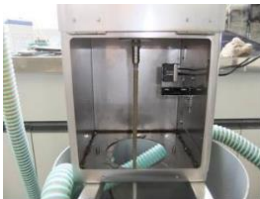
図 161. 試作した濁質モニターの外観と内部構造
