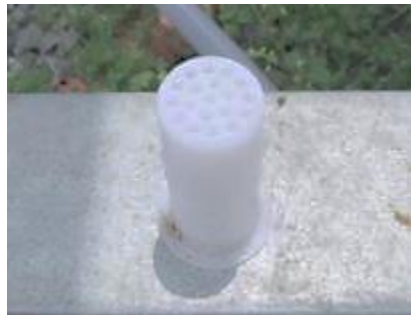
図 87 モジュール上部流出ノズル内に挿入した中空糸引込防止具
