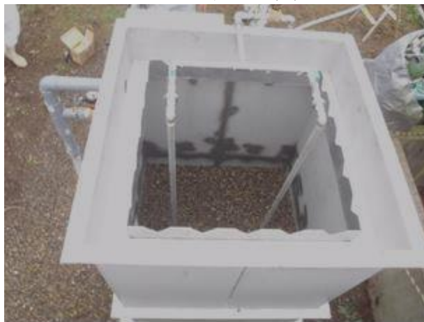
図 52 上向流式硫黄脱窒槽の事例 (硫黄資材投入前)
