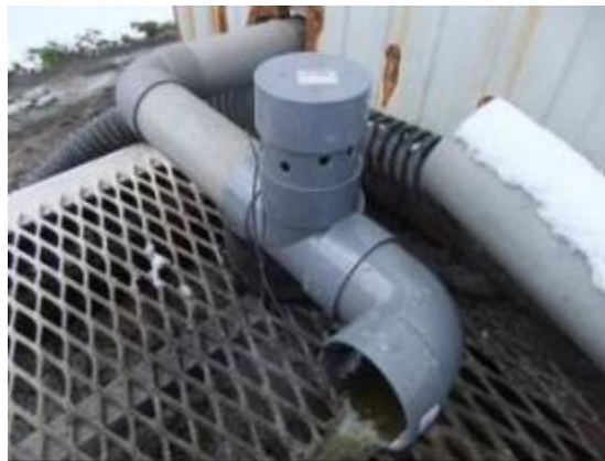
図 184 センサーを設置した脱水分離液流出口（上部の円形蓋の裏側にセンサーを固定）
