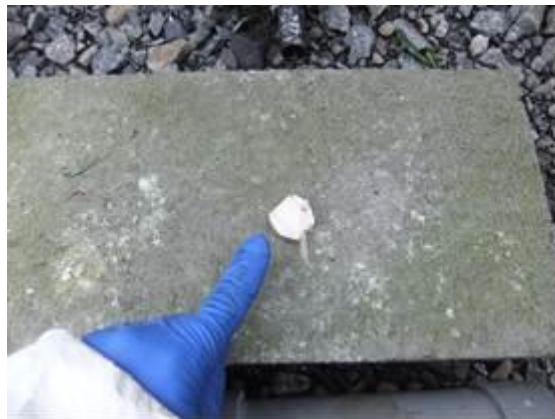
図 107 配管に閉塞していたプラスチック片
