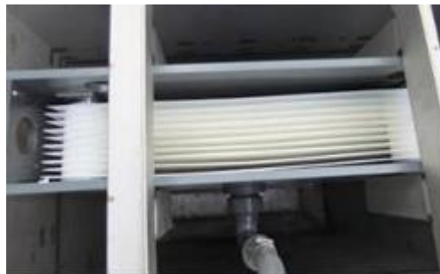
図 29. 平膜モジュールの内部構造
