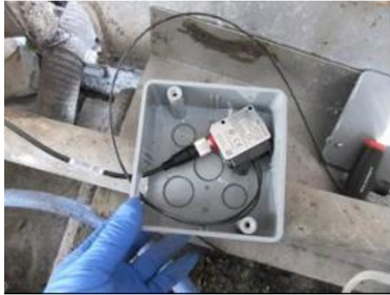
図 186 センサー光源部の状況（本体とヘッドの間は光ファイバーで接続）
