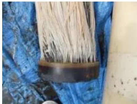
図 113 モジュール下部中空糸束への豚毛の付着状況
