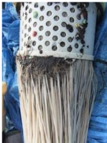
図 114 モジュール上部の豚毛付着状況
