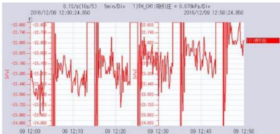
図 70. 樹脂粒添加後 1 時間における定流量時ろ過差圧の変化
