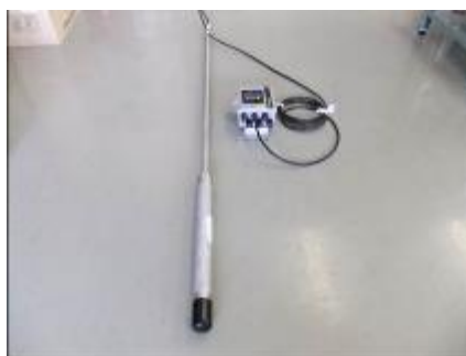
図 35 現場設置式 MLSS 計の事例
