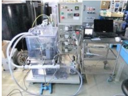
図 145 室内型膜分離試験装置
