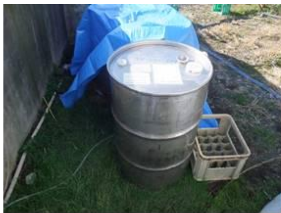
図 44 メタノール溶液貯留用タンク
