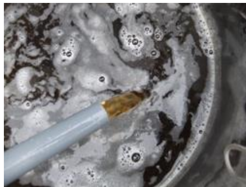
図 126 排出苛性ソーダ溶液のステンレスタンクへの回収状況 (排出液の色を見るために排出管を持ち上げているが 通常は底部まで挿入した状態で行う)
