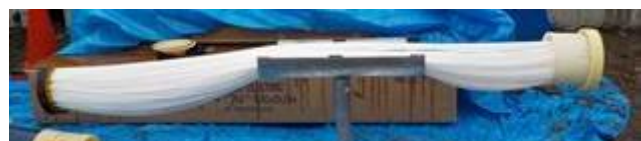
図 33 使用する膜モジュール（直径 24cm×2m） （左：外筒部、右：装填する中空糸束）
