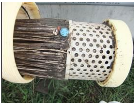
図 108 モジュールの液流出部に付着していたプラスチック片
