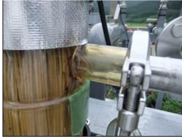
図 86 ノズル内に引き込まれて切断した中空糸
