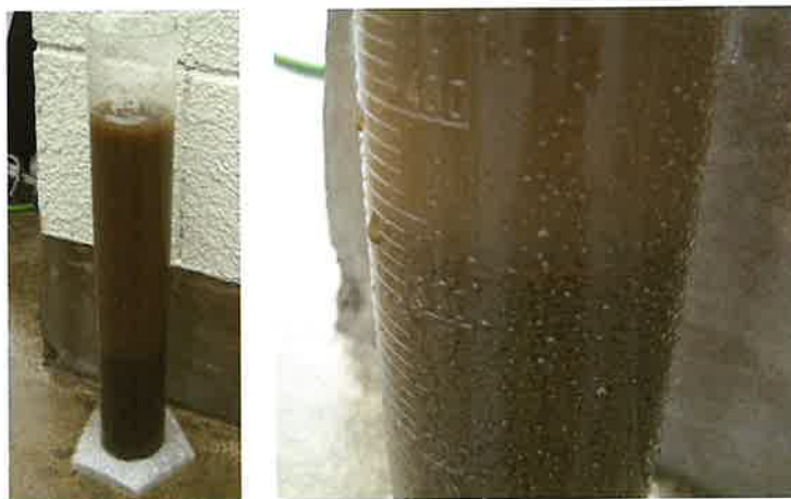
凝集性が悪く汚泥の一部が溶解している活性汚泥 （汚泥がふわふわしており、上澄みが激しく濁っている）
