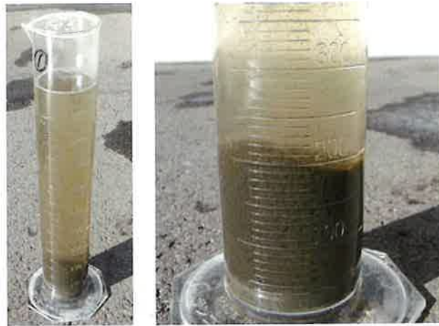
沈降性の悪い活性汚泥（上澄みに汚泥が浮遊し、汚泥界面が波打っている）
