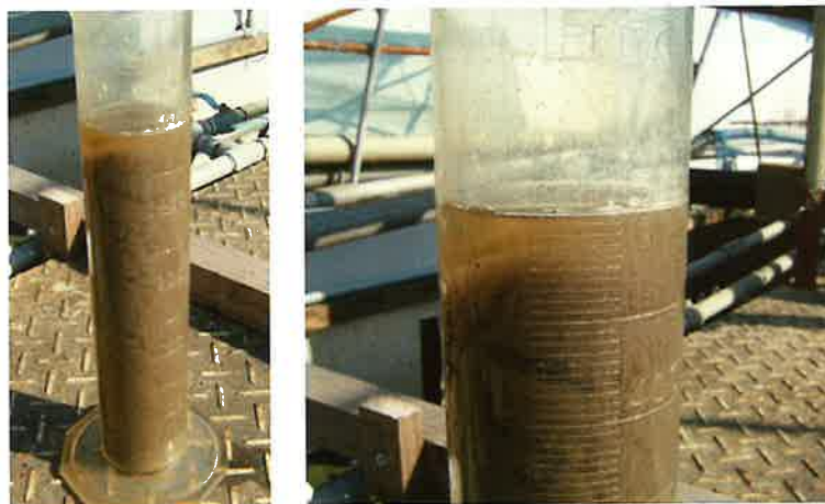
凝集性の悪い活性汚泥（SV30が高く、沈降した汚泥に大きな隙間ができている）
