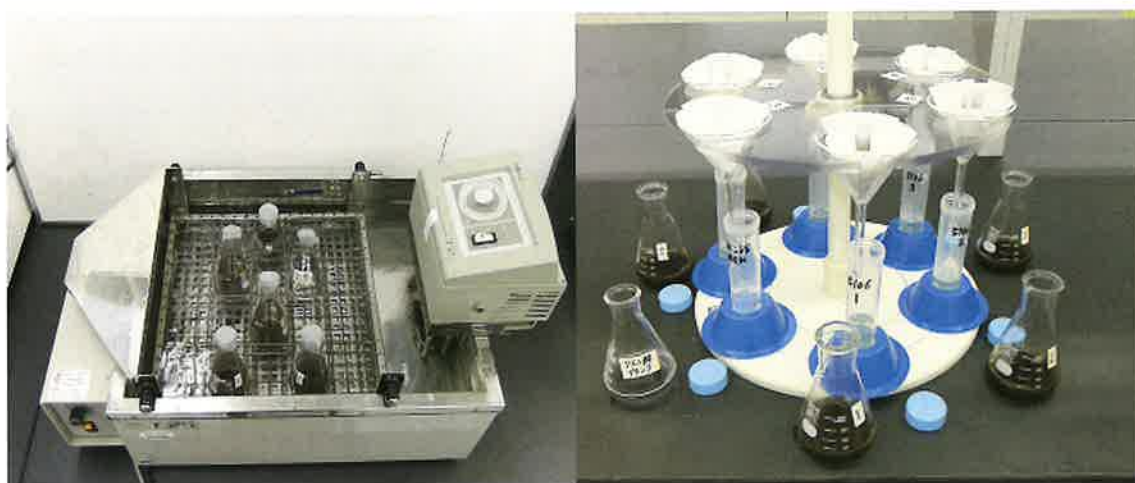
写真4-1 く溶性リン酸の抽出操作 写真4-2 く溶性リン酸のろ過操作
