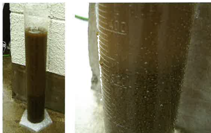
凝集性が悪く汚泥の一部が溶解している活性汚泥 （汚泥がふわふわしており、上澄み液が激しく濁っている）
