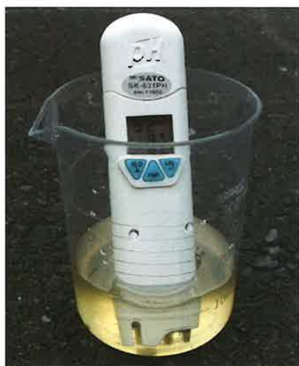
簡易なpH計（左）やpH試験紙（右）での測定
