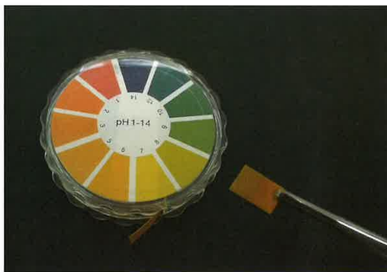
簡易なpH計（左）やpH試験紙（右）での測定
