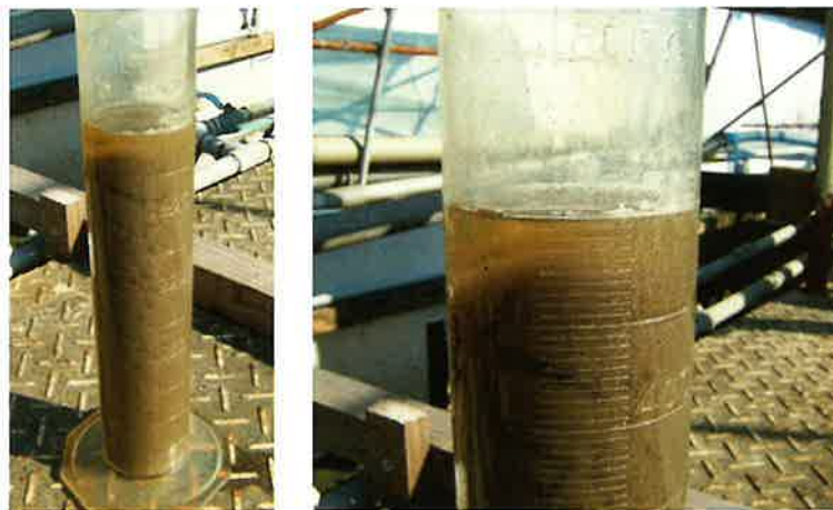
凝集性の悪い活性汚泥（SV30が高く、沈降した汚泥に大きな隙間ができています）
