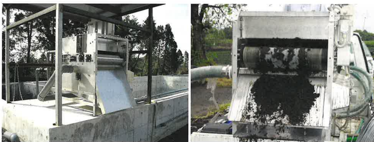
図6-18 ベルトスクリーン型固液分離機
