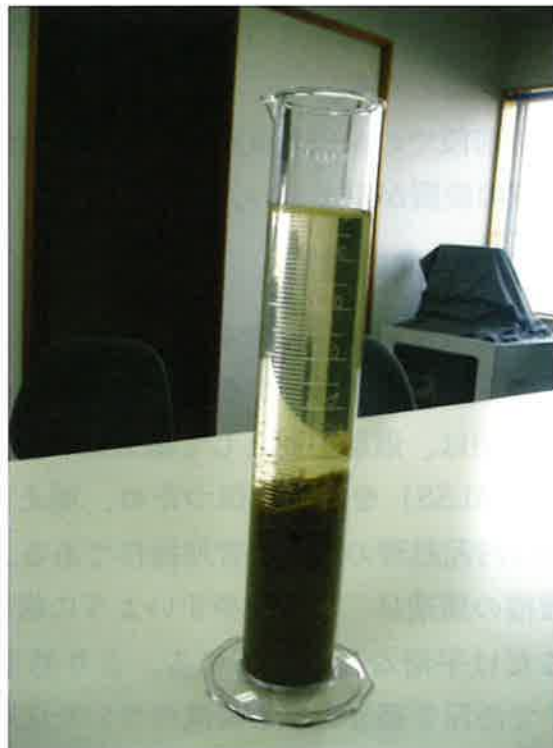
図7-10 正常な活性汚泥のSV測定の場合 (活性汚泥の凝集性が良く、沈降性が良好で上澄み液が透明)
