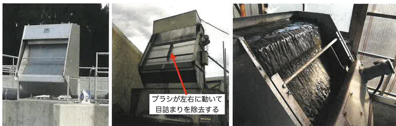
図6-14 傾斜スクリーン型固液分離機
