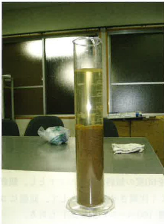
図7-10 正常な活性汚泥のSV測定の場合 (活性汚泥の凝集性が良く、沈降性が良好で上澄み液が透明)
