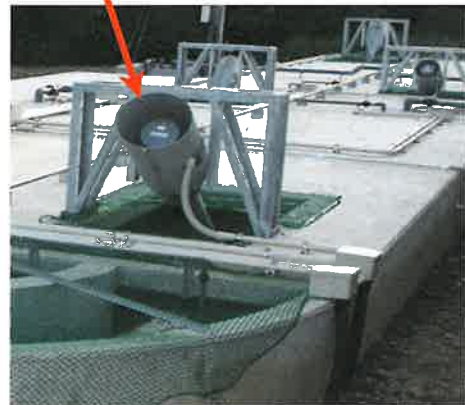
図7-17 スクリュー型曝気装置
