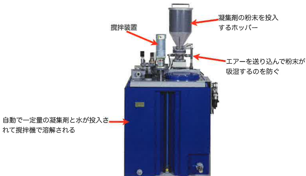
図6-33 高分子凝集剤自動溶解装置
