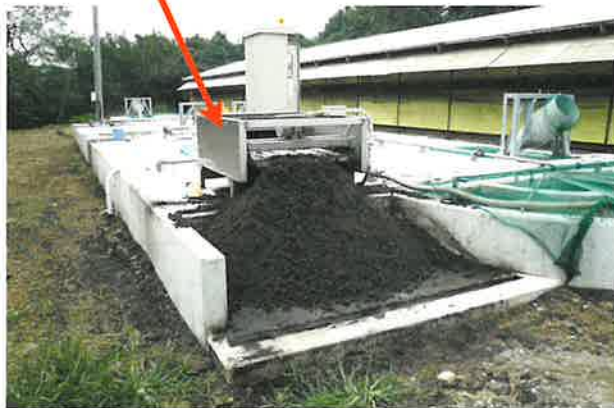
図7-16 振動篩型固液分離機
