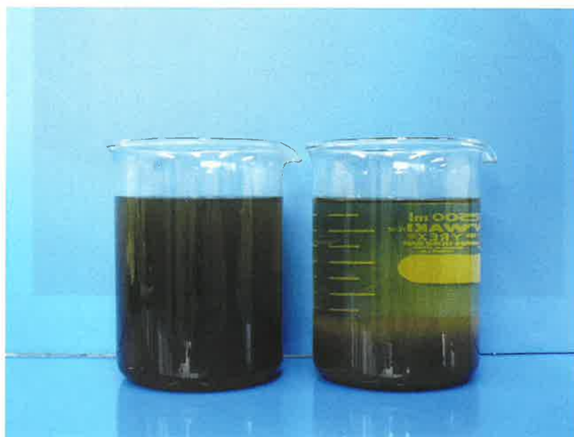
図6-26 凝集剤添加前（左）と凝集剤添加後（右）の汚水 （右側はSSが凝集して沈殿している）
