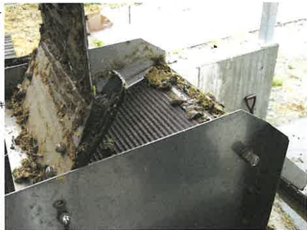
図6-31 多板波動型脱水機の外観（上）、固液分離部分の構造（左下）、固液分離部分のウェイトを上げたところ（右下）（ジャステック（株）提供）
