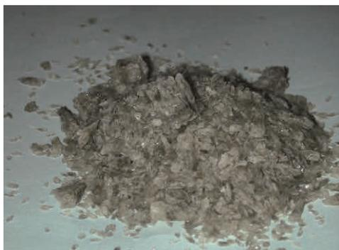
図 1. 汚水から生成したリン酸マグネシウムアンモニウム（MAP）の結晶
