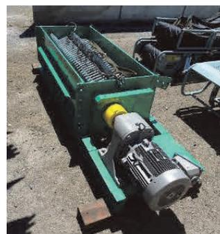
図5 原料破砕機
