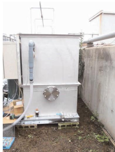
図3 上向流方式リアクターの構造と実証試験装置
