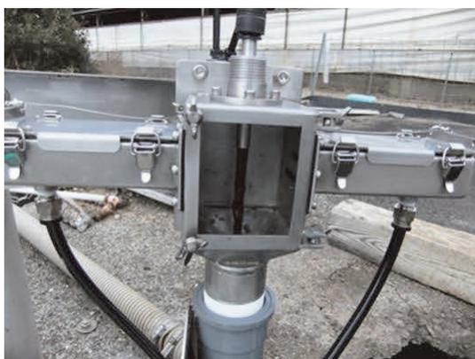
図1 実証試験中の MLSS モニタ
