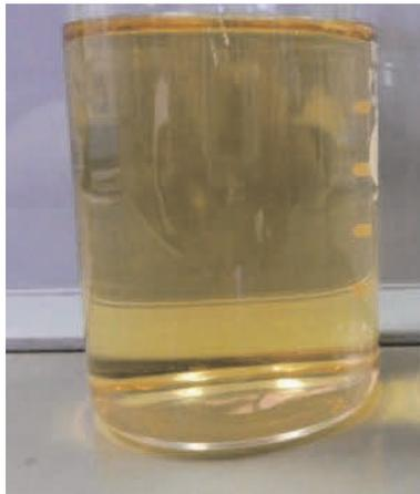
図1 膜分離後の処理水の着色状況
