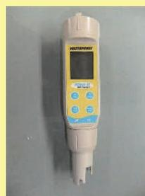
図2. ポケット型pH・EC計の事例
