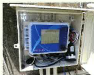
図 1 4. データ記録機能付き水温、pH、EC、ORP 測定器の事例
