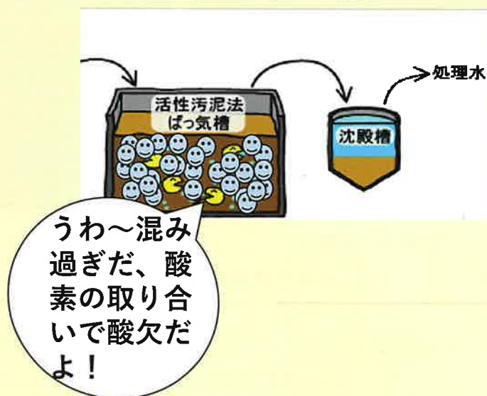
図9. 活性汚泥濃度が高すぎると酸素不足で窒素除去はストップ
