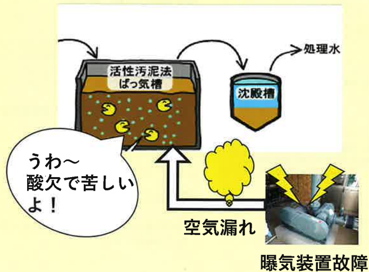
図8. 酸欠の原因となる曝気関係機器の不調
