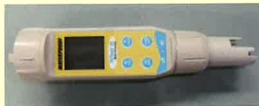
図 2. 水温、pH、EC 用ポケット計測器の事例 (これ一台で水温、pH、EC が測定できます。価格は約 3 万円です)
